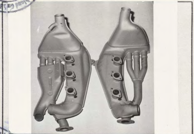
J) Auspußkrümmer Exhaust manifold
