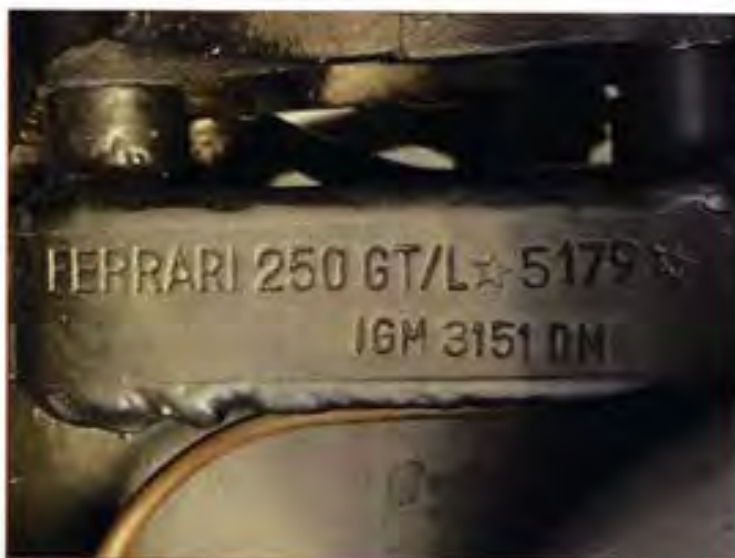
Foto posizione telaio (sul telaio) Photograph of the chassis number (on the chassis)
