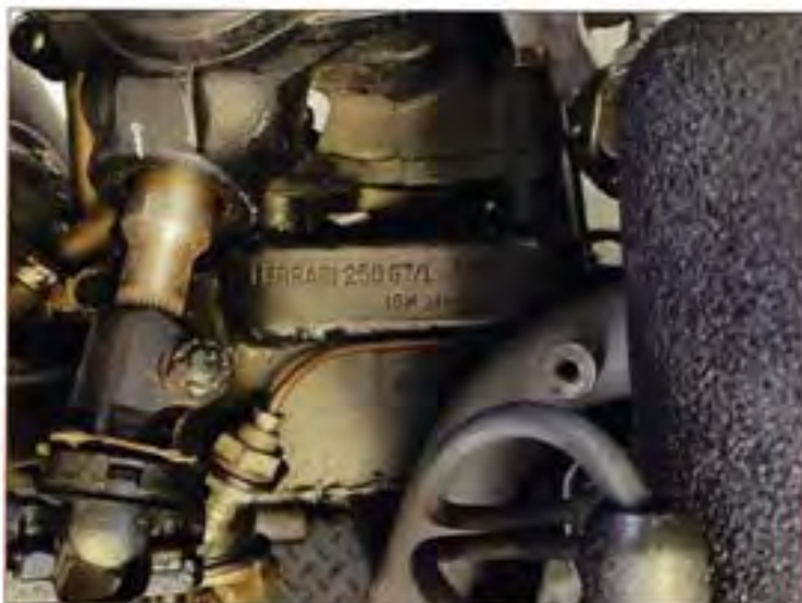
Posizione numerata telaio Chassis number position
