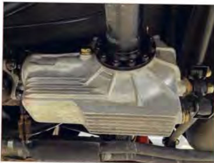
Foto differenziale in vettura (solo nel caso i gruppi siano divisi) Photo of the differential in the car (if the gearbox/differential units are separated)
